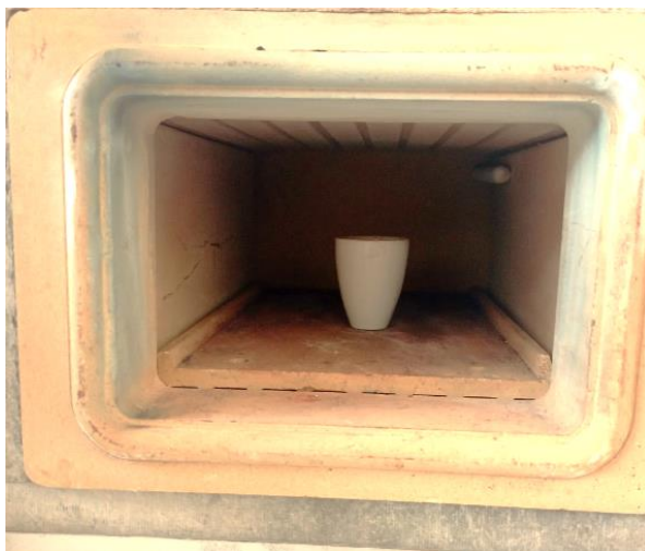
3-rasm. Rux keki va texnik oltingugurtdan iborat aralashmani Mufel pechida qizdirish jarayoni
