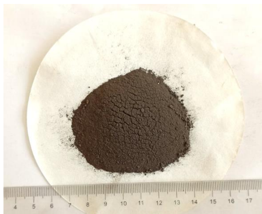
3-rasm. Rux kekini maydalangan texnik oltingugurt bilan ko‘machlangandan so‘ng hosil bo‘lgan mahsulotni magnitli fraksiyasi
