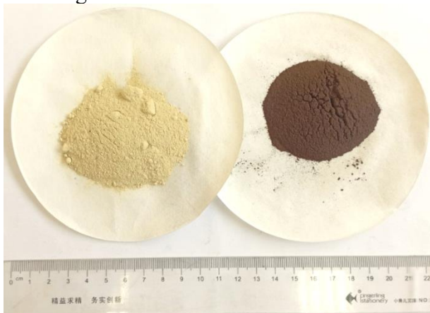
1-rasm. Rux keki (o‘ngda) va maydalangan texnik oltingugurt (chapda) namunasining granulometrik tahlili
