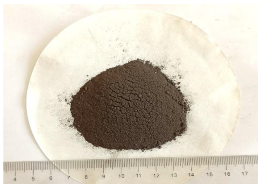
3-rasm. Rux kekini maydalangan texnik oltingugurt bilan ko‘machlangandan so‘ng hosil bo‘lgan mahsulotni magnitli fraksiyasi
