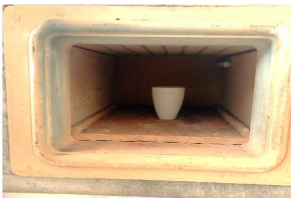
3-rasm. Rux keki va texnik oltingugurtdan iborat aralashmani Mufel pechida qizdirish jarayoni
